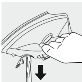
3. Наполните резервуар водой через специальное отверстие.
