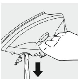
3. Наполните резервуар водой через специальное отверстие.
