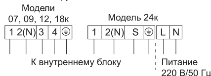
Терминал для подключения проводов на наружном блоке
